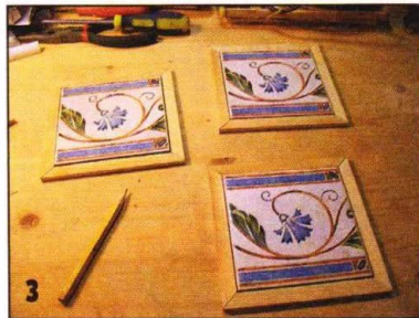
3 Не соединяя элементы, примерил подготовленные рамки к плиткам.
