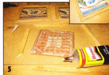
5 Я взял плотный, но тонкий картон и наклеил на него как саму плитку, так и детали рамки вокруг неё.
